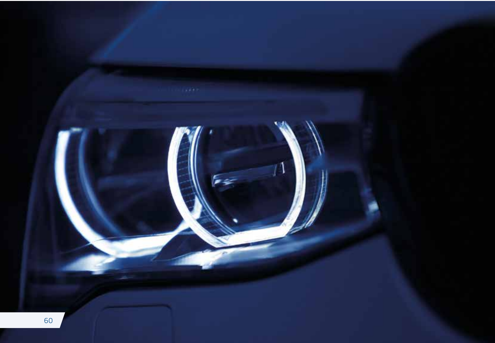
Złożony system optyczny z automatycznym systemem poziomowania oraz funkcją czyszczenia reflektorów
