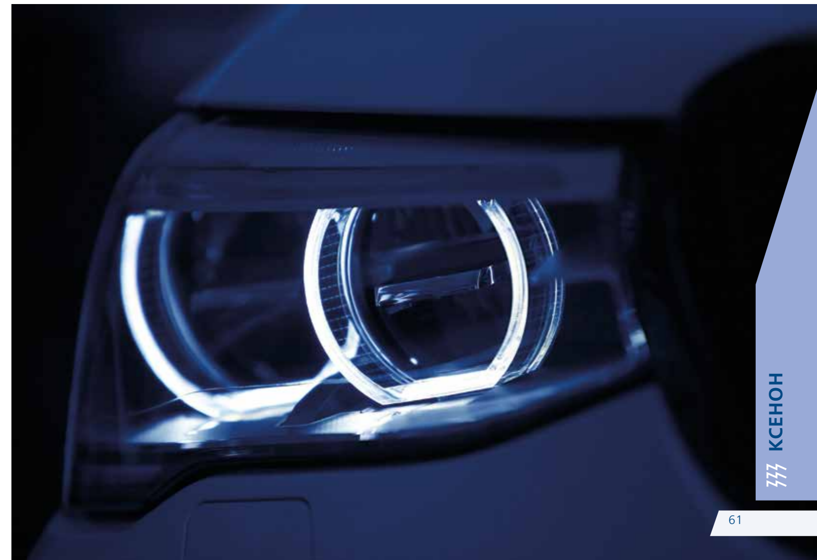
Сложная оптическая система с автоматическим корректором фар и системой очистки
