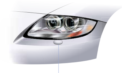
Sistema óptico sofisticado com nível de controlo automático e sistema de lava-faróis de alta pressão
