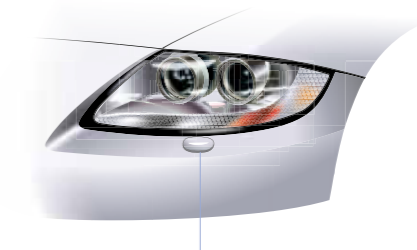
Sistema ottico complesso con controllo automatico del livello e sistema power-wash
