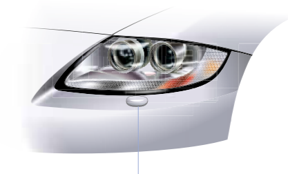
Összetett optikai rendszer automatikus szintbeállítással és villanymotoros fényszórómosó rendszerrel
