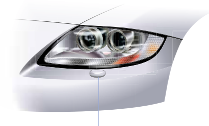
Complejo sistema óptico con control de nivel automático y sistema de lavado electrónico
