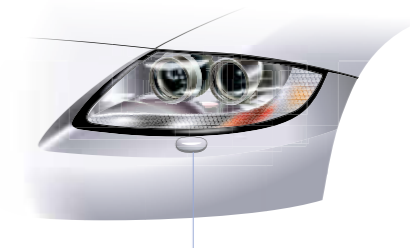
Komplexes optisches System mit automatischer Niveauregelung und Reinigungsanlage
