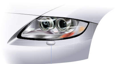
Complejo sistema óptico con control de nivel automático y sistema de lavado electrónico
